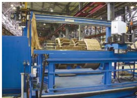
Изготовление обмоток ведется на горизонтальных намоточных станках фирмы «Tuboly AG» (Швейцария)
