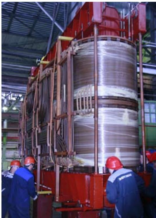
Подготовка к установке активной части трансформатора в бак
