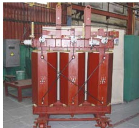
Трансформатор ТС3-1600/10 УЗ АЛ
