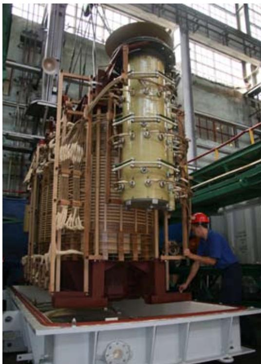
Установка активной части трансформатора в бак
