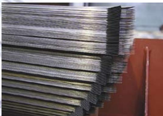
Сборка и шихтовка магнитопровода по технологии Step-lap
