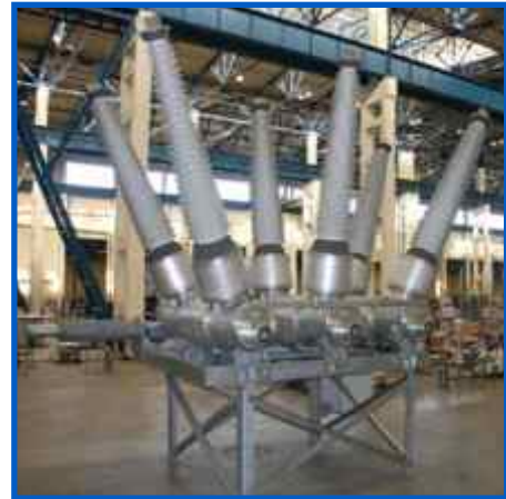
Элегазовый выключатель ВЭБ-220
