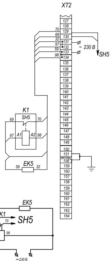
Вариант подключения сигнализаторов полюса ВГТ-220
