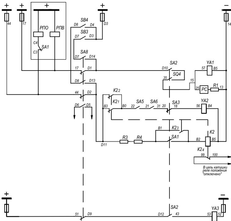
Примечание. 1. Реле положения выключателя (РПО и РПВ) в состав схемы привода не входят.
