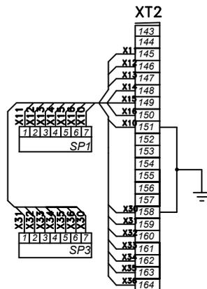
Схема контактов сигнализатора плотности
